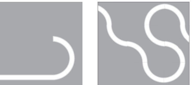
Przykład łączenia w linię świetlną: ARC 800mm i LINE 1085mm In-line installation: ARC 800mm and LINE 1200mm
